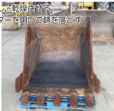
ケレン清掃完了
